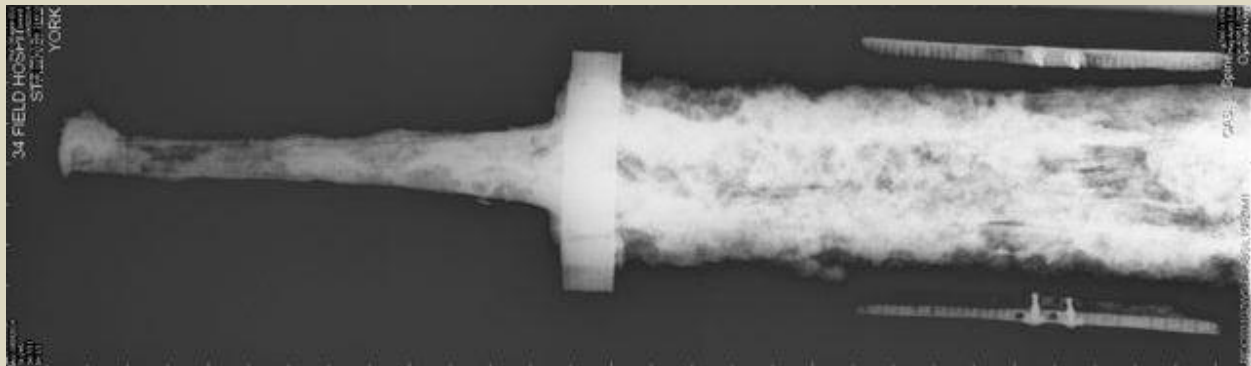
عکس برداری با اشعه X برای سنجش میزان خوردگی و آسیب دیدگی فلزات
